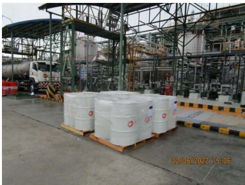
รูปที่ 27 ถังเก็บน้ำมันหล่อลื่น ที่ผ่านการใช้งานแล้วที่มีฟอสฟอรัส
