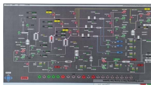
รูปที่ 6 จอแสดงการรวบรวมสาร VOCs จากกระบวนการผลิตและดึงเก็บเพื่อนำไปทำลายที่เตาเผา
